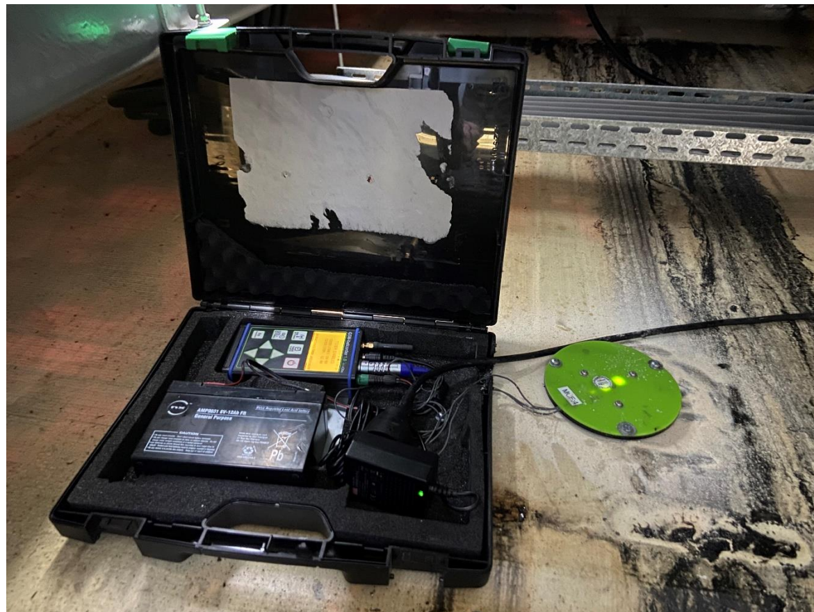
Figure 10 : Cliché de l'installation d'un Batcorder dans la nacelle de l'éolienne d'un autre parc avec micro à travers la paroi de la nacelle)
