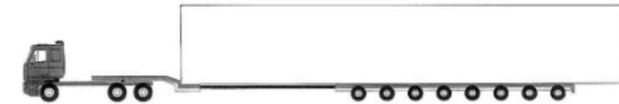
Figure 27 : Transport d'un mât
