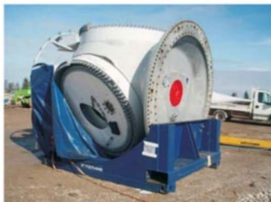
Figure 34 : Stockage d'un rotor sur une plateforme (Source : EDF power solutions)
