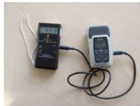
PETTERSSON D240X couplé à un enregistreur numérique
